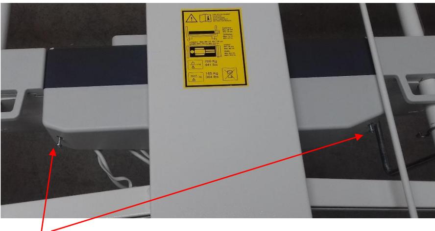
Enlever les 2 vis du capot (tournevis cruciforme) sortir sur quelques centimètres les câbles des goulottes si besoin.
