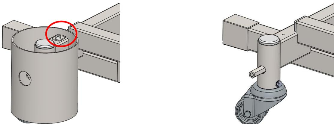
Retirer le 6 pan et deviser la vis de la roulette.
